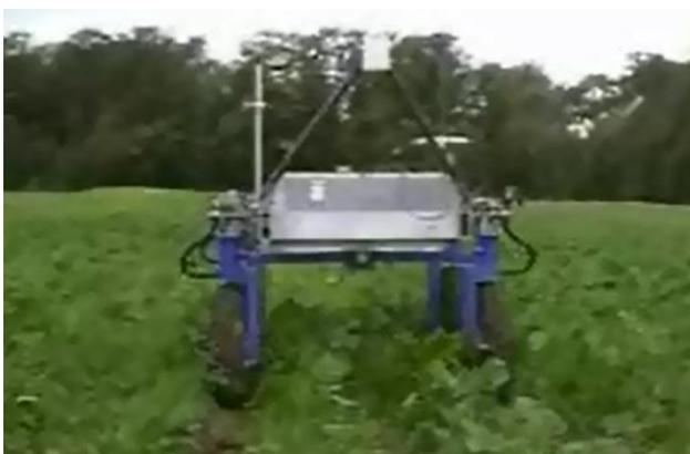
Рисунок 4.3 – Авторобот с высококлиренсным шасси
