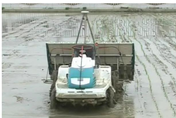
Рисунок 4.4 – Рассадопосадочная машина для выращивания риса
