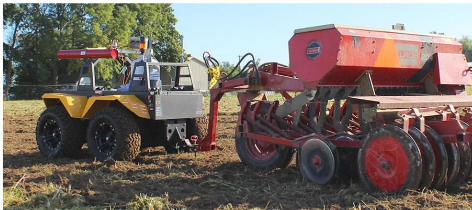
Рисунок 4.30 – Роботизированный внедорожник
