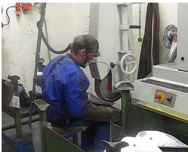
Рисунок 4.7 – Ручная шлифовка отвалов плуга
