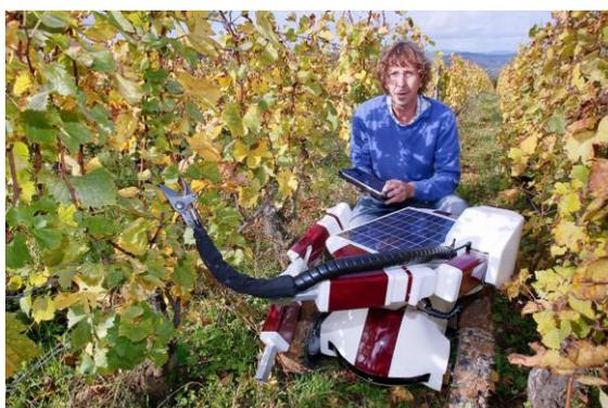
Рисунок 4.20 – Робот для обрезки виноградников
