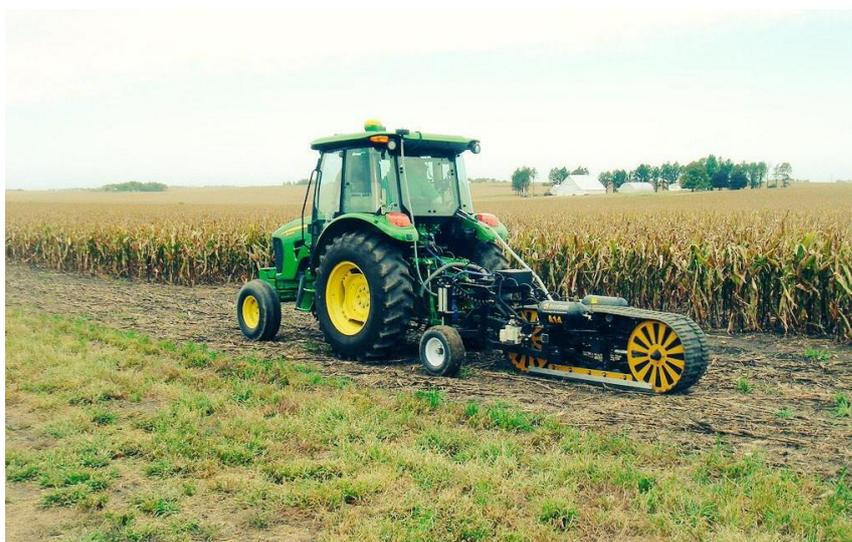
Рисунок 4.31 – Система для взятия почвенных образцов
