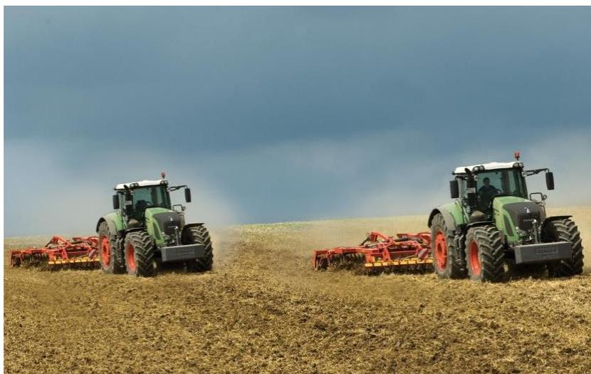
Рисунок 4.32 – Двойная система AGCO Fendt GuideConnect
