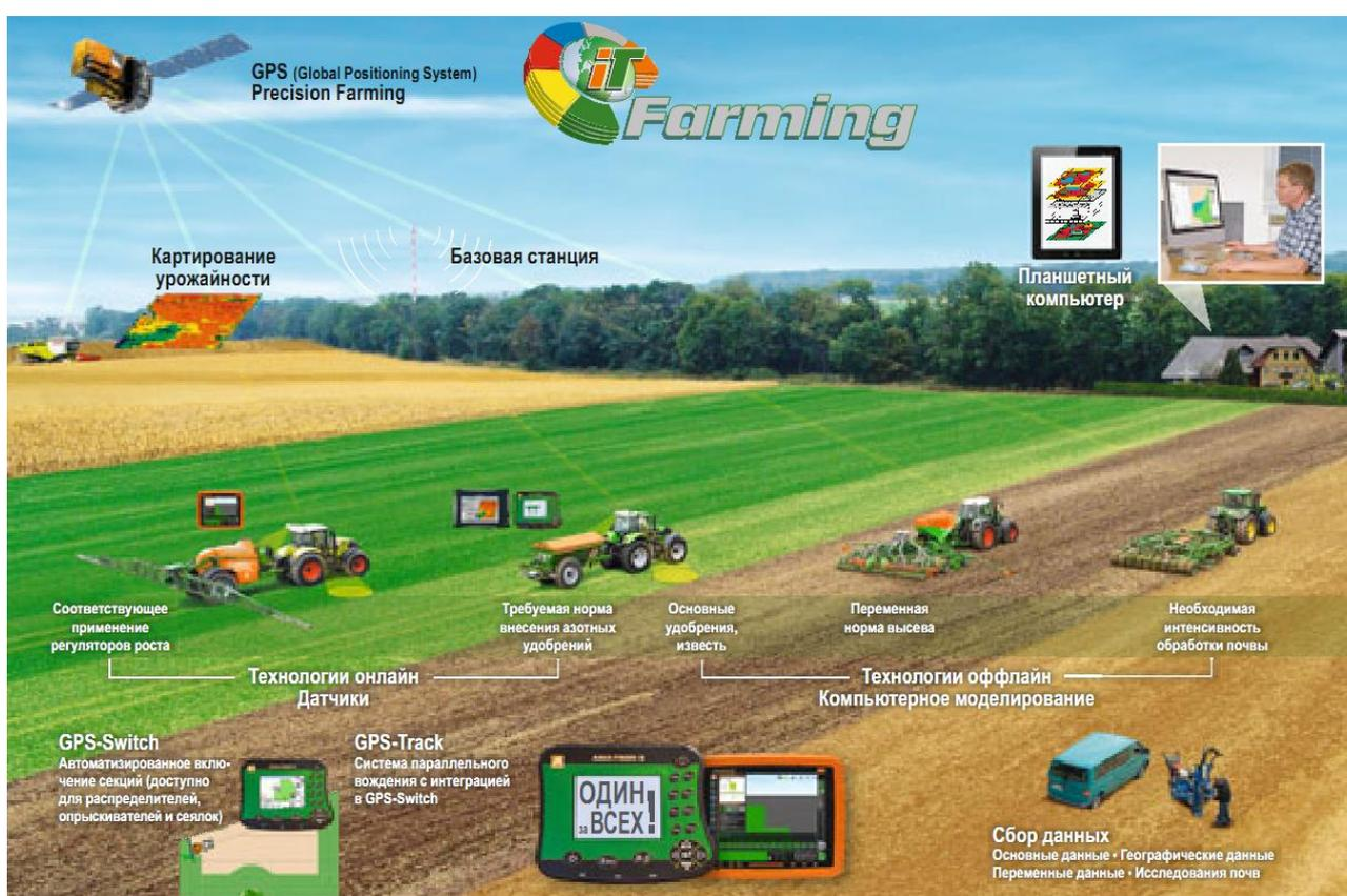
Рисунок 70 – Обмен данными между терминалом Amaraд 3 и прочими технологиями IT-Farming осуществляется через определенные и открытые интерфейсы
