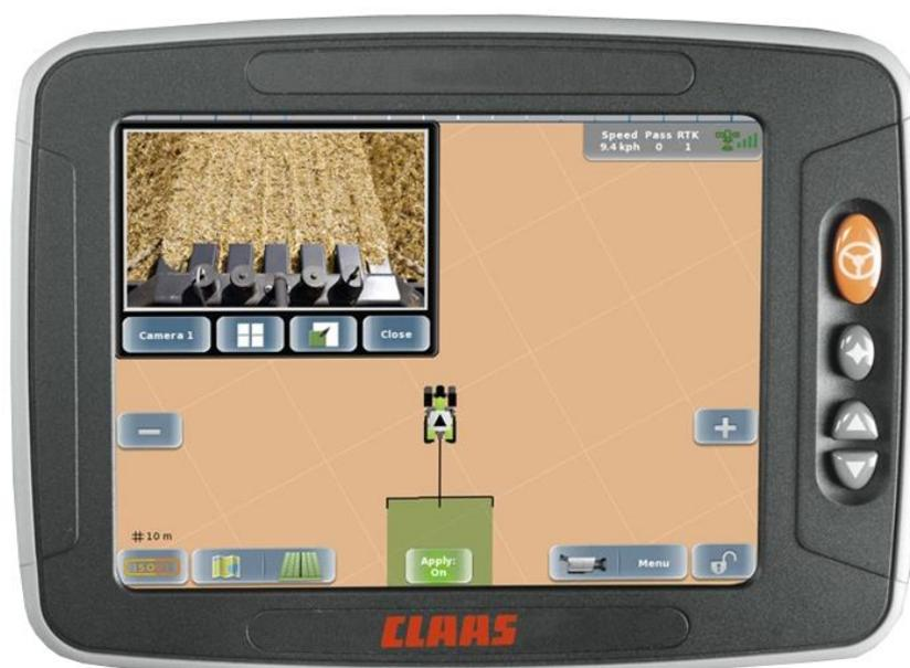
Рисунок 9 – Вывод на экран изображения с камеры
