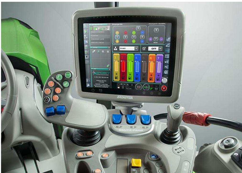
Рисунок 75 – Терминал i-Monitor 2
