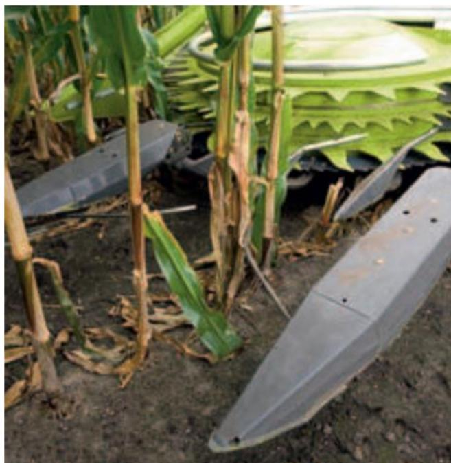
Рисунок 15 – Механические скобы-копиры
