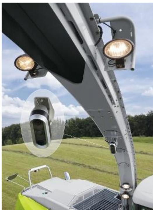
Рисунок 12 – Камера контроля уровня заполнения кузова
