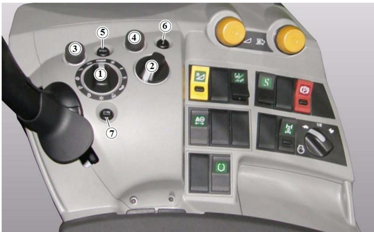
Рисунок 24 – Пульт управления бортовой информационной системы:
