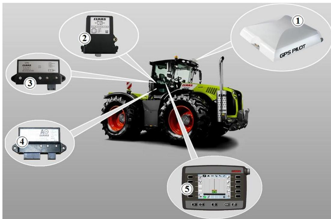
Рисунок 29 – Система GPS Pilot:
