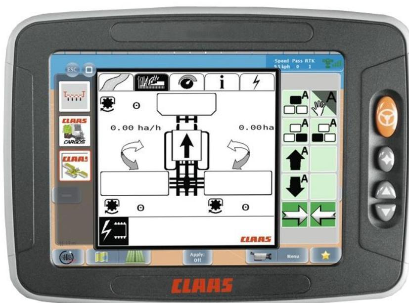
Рисунок 8 – Вывод на экран и управление совместимым навесным оборудованием
