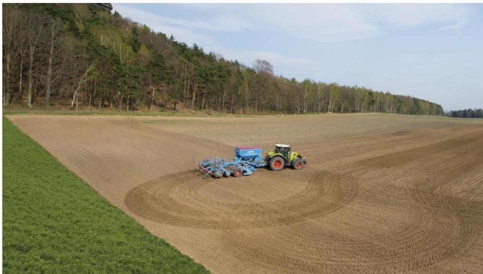
Рисунок 7 – Работа агрегата с функцией автоматического маневрирования с разворотом в режиме Auto Turn
