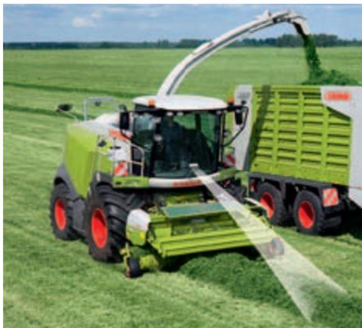
Рисунок 16 – Работа комбайна с системой Cam Pilot
