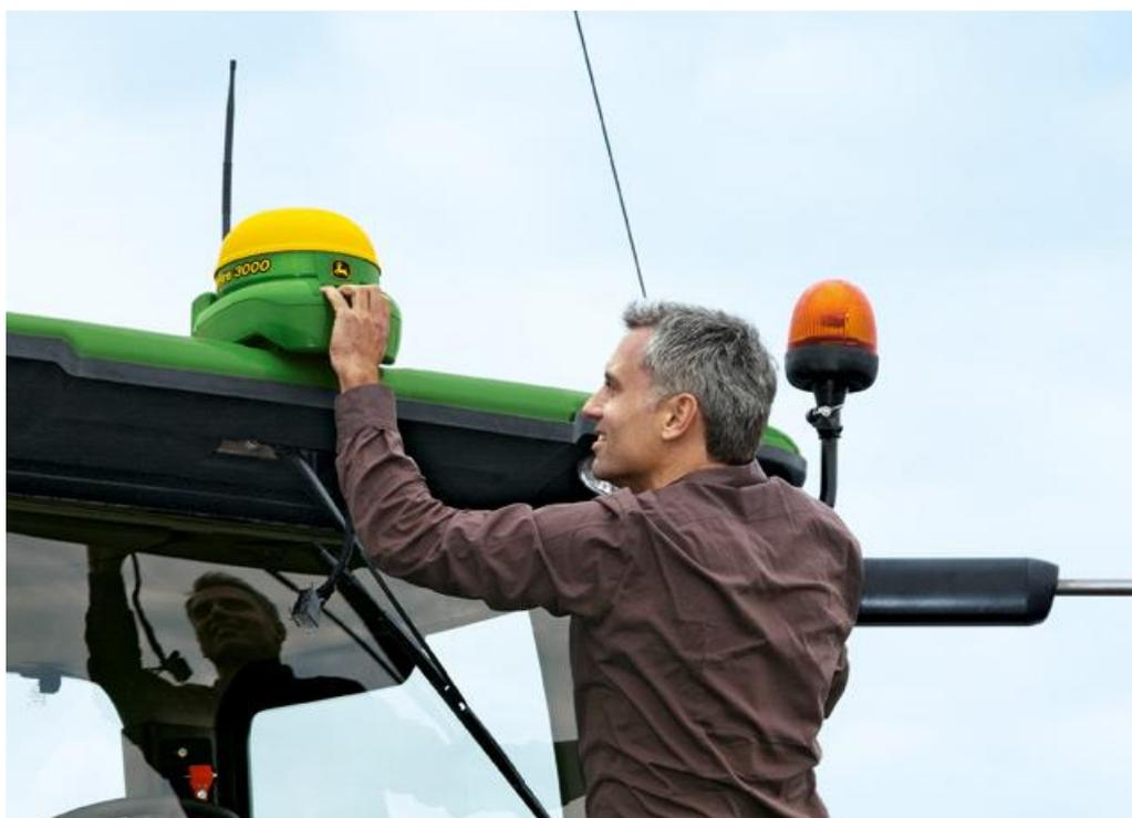
Рисунок 53 – Установка приемника StarFire 3000
