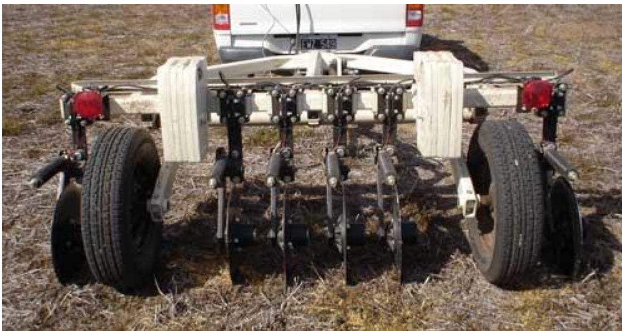
Рисунок 3 – Картирование электропроводности почвы с помощью прицепной машины Veris 3100 (компания Veris Technologies, США)
