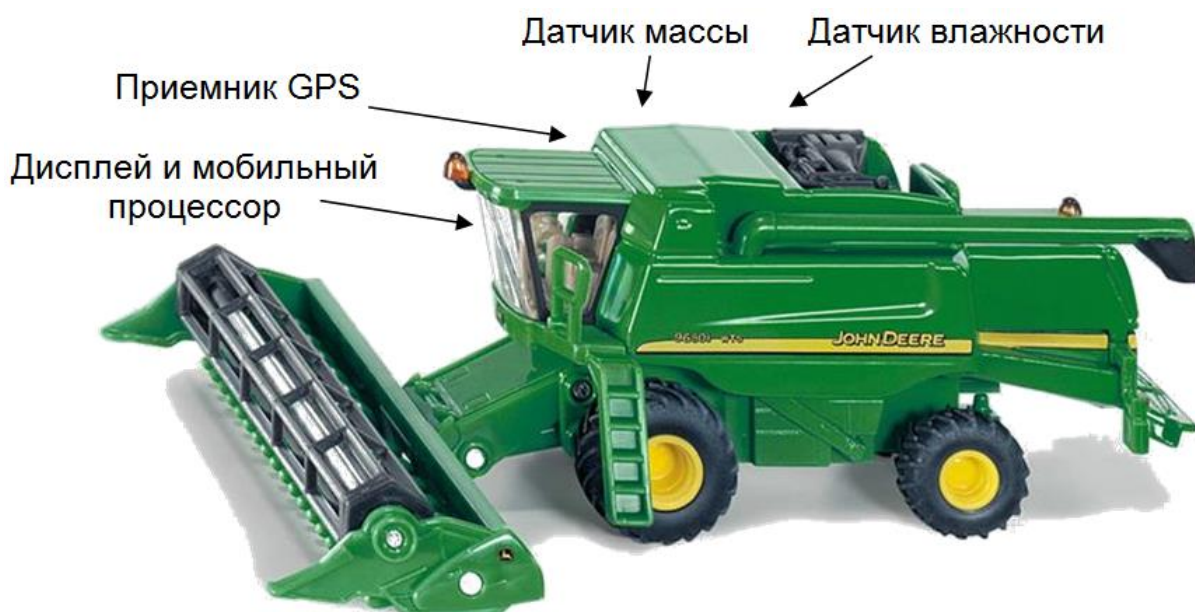
Рисунок 4 – Комбайн, оснащенный оборудованием для картирования урожайности
