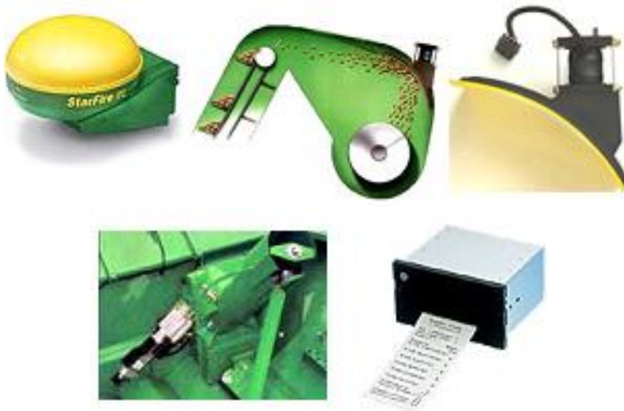
Рисунок 3 – Элементы системы картирования урожайности
