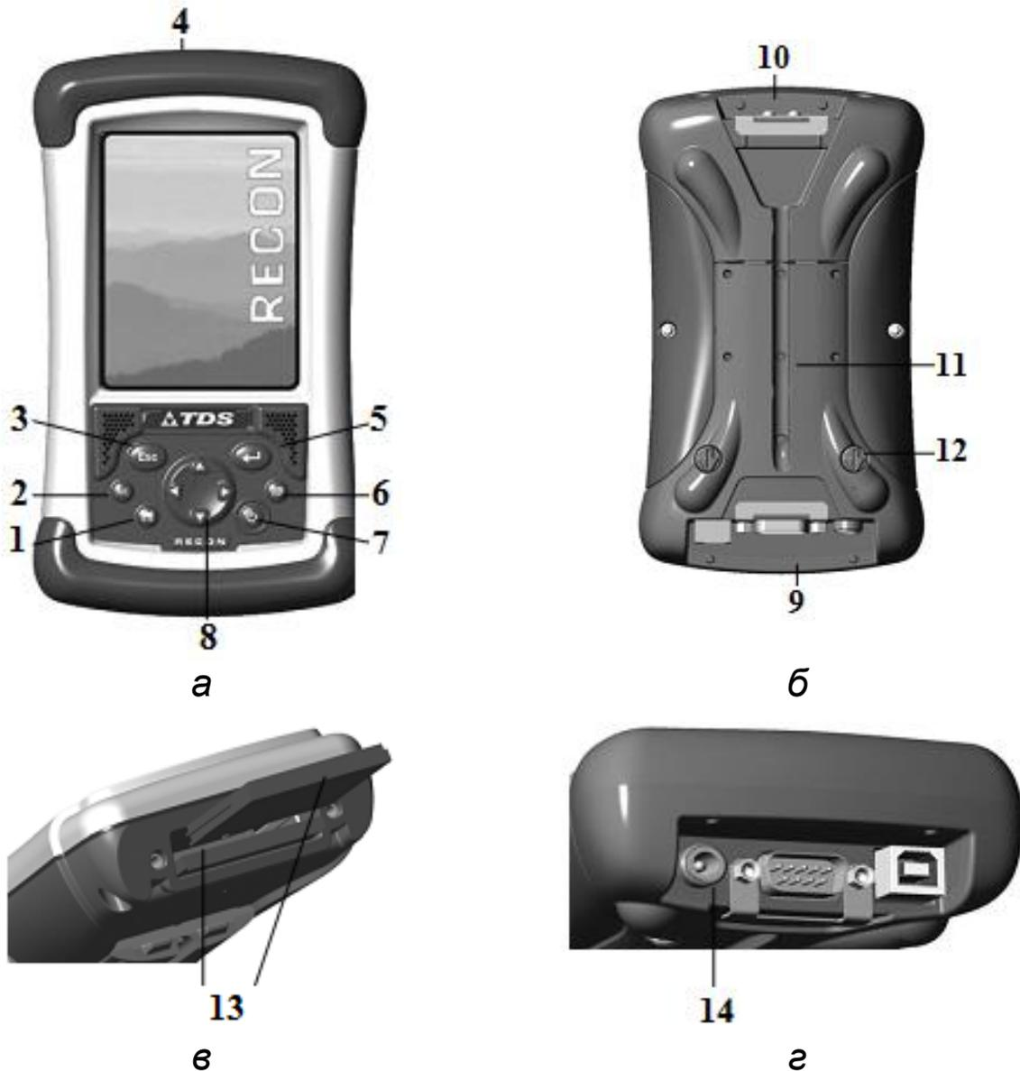
Рисунок 12 – Полевой компьютер Trimble Recon
