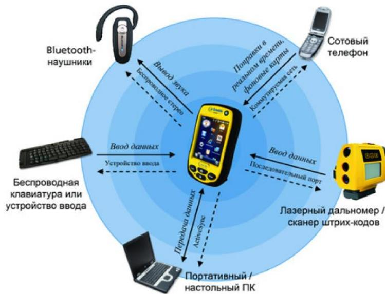
Рисунок 19 – Подключение контроллера серии Juno в качестве Bluetooth-клиента
