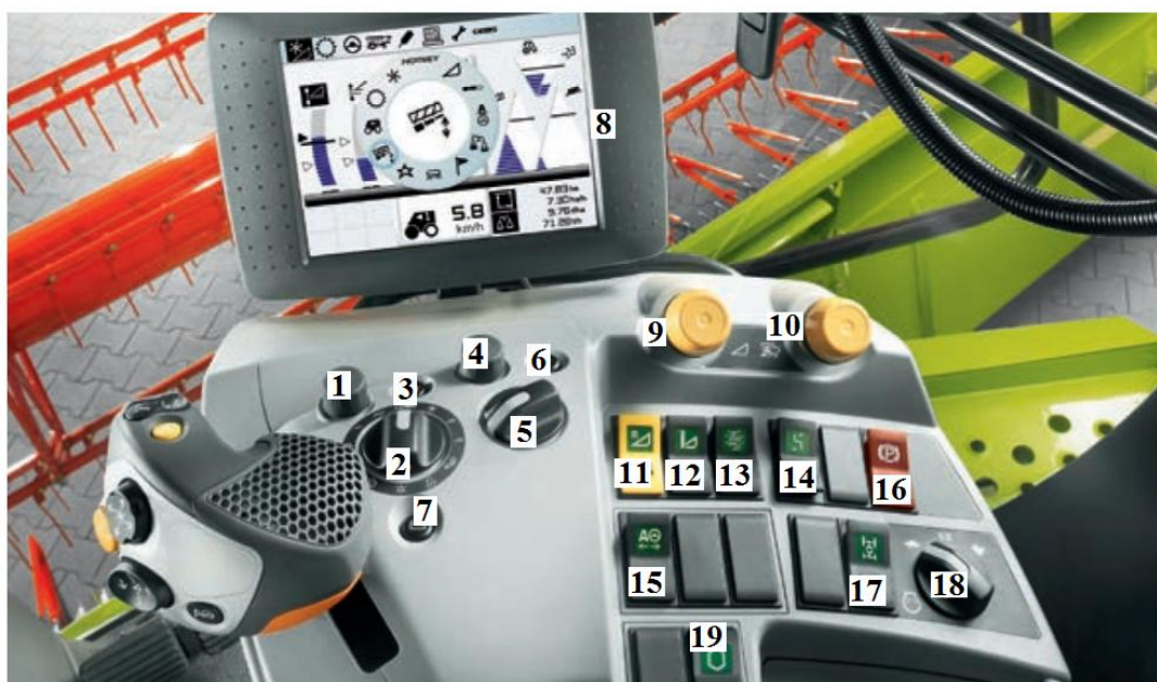
Рисунок 1.11 – Функциональные выключатели пульта управления:
