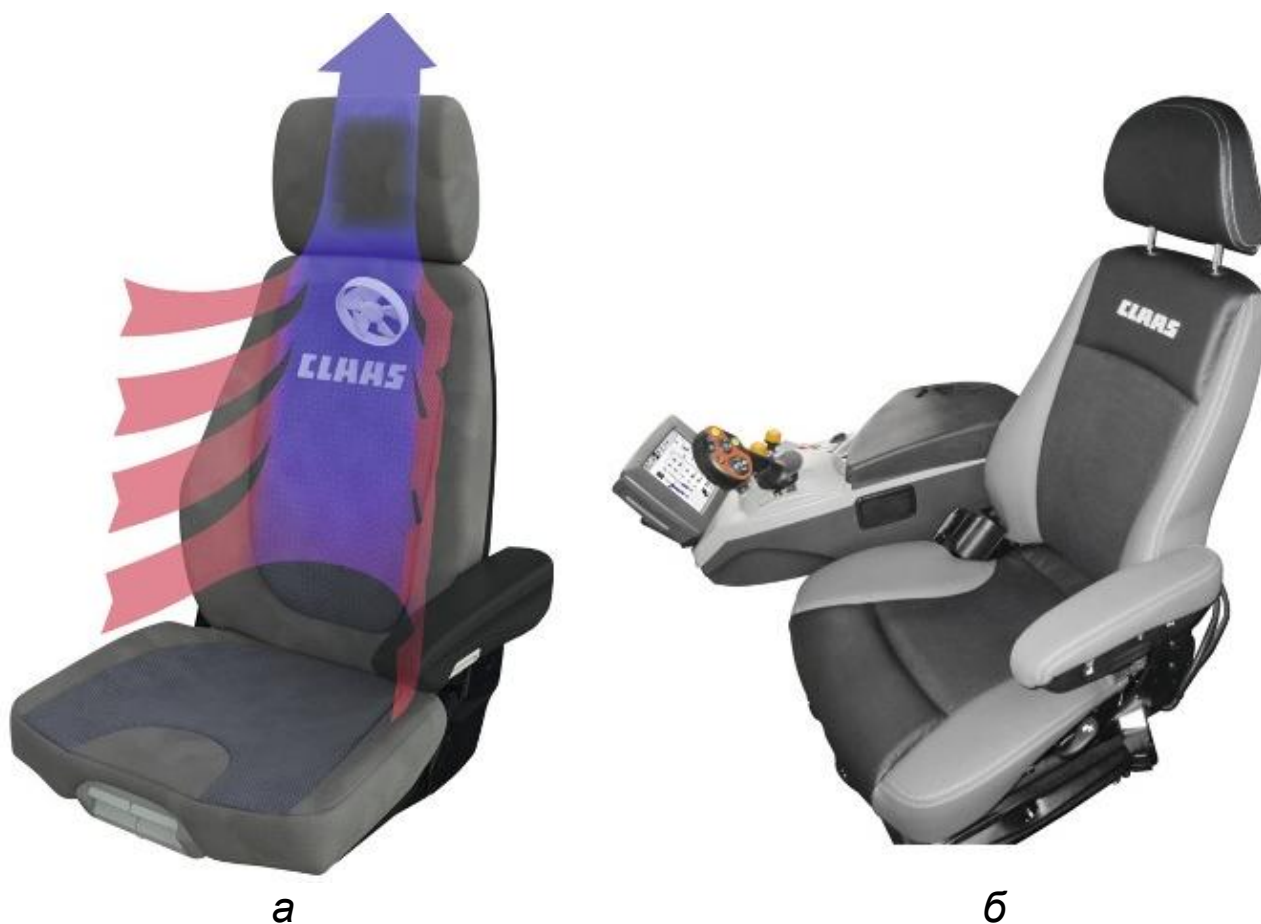
Рисунок 1.8 – Кресло комбайна Lexion 770: а – премиум-класса; б – кожаное сиденье
