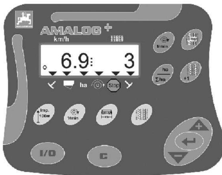
Рисунок 13.10 – Терминал Amalog+
