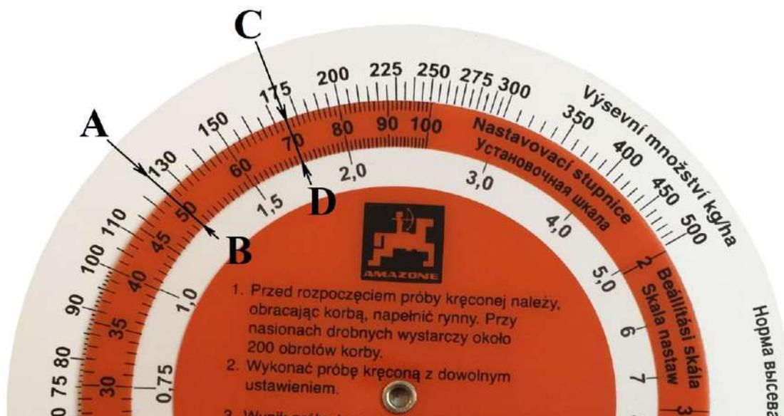
Рисунок 13.17 – Определение положение рычага редуктора с помощью логарифмического диска
