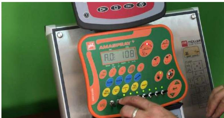
Рисунок 5.3 – Отключение секций
