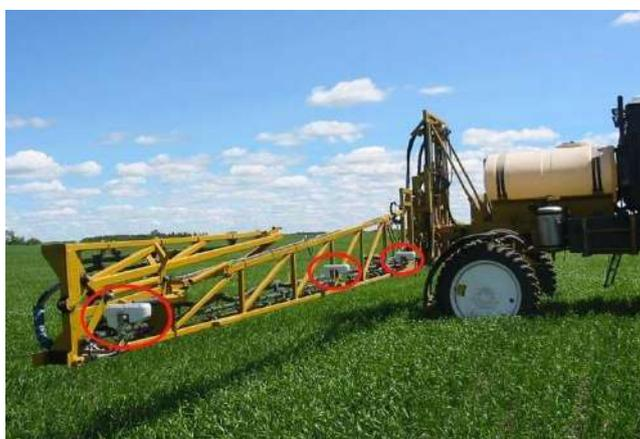
Рисунок 12.3 – Датчики GreenSeeker RT200
