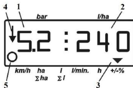
Рисунок 4.2 – Дисплей бортового компьютера Amaspray+
