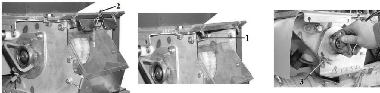
Рисунок 13.11 – Замена дозирующего вала в дозаторе:
