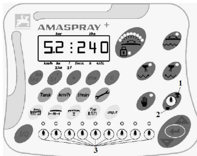
Рисунок 4.3 – Переключатель опрыскивания:
