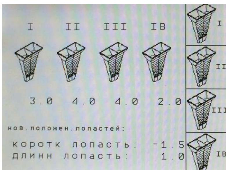
Рисунок 11.8 – Определение нового положения лопастей
