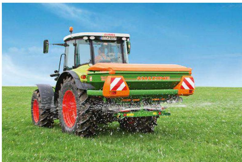
Рисунок 7.3 – Машина для внесения удобрений Amazone ZA-M
