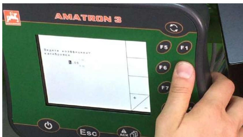
Рисунок 11.16 – Настройка коэффициента калибровки
