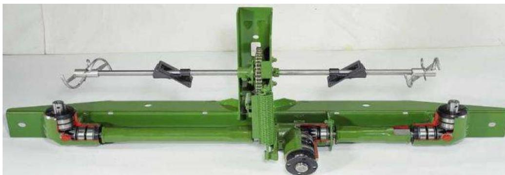
Рисунок 8.11 – Распределительное устройство
