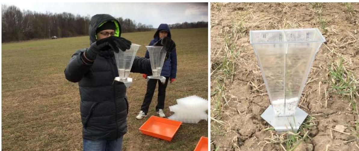
Рисунок 11.3 – Бункера для определения количества удобрений
