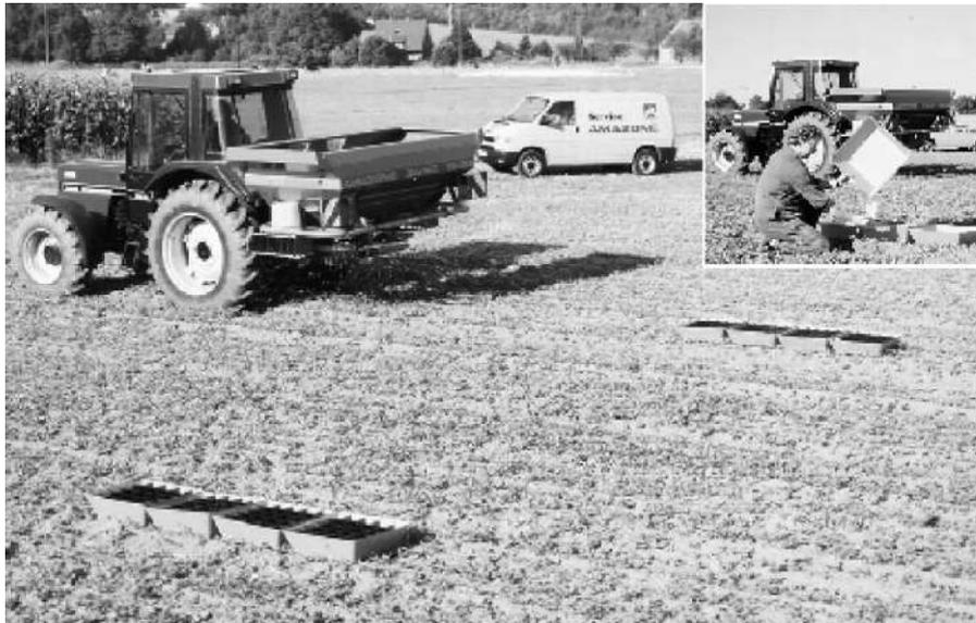
Рисунок 10.9 – Мобильный испытательный стенд
