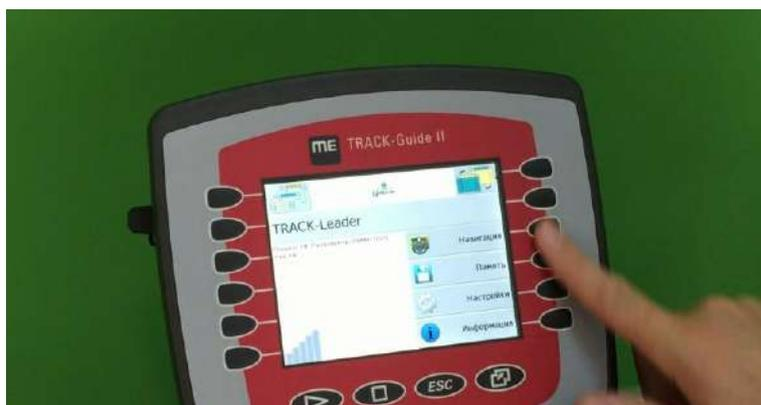
Рисунок 5.4 – Переход к режиму **Навигация**
