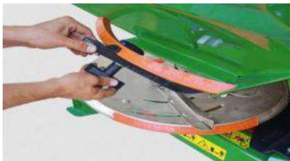
Рисунок 9.9 – Установка положения заслонки
