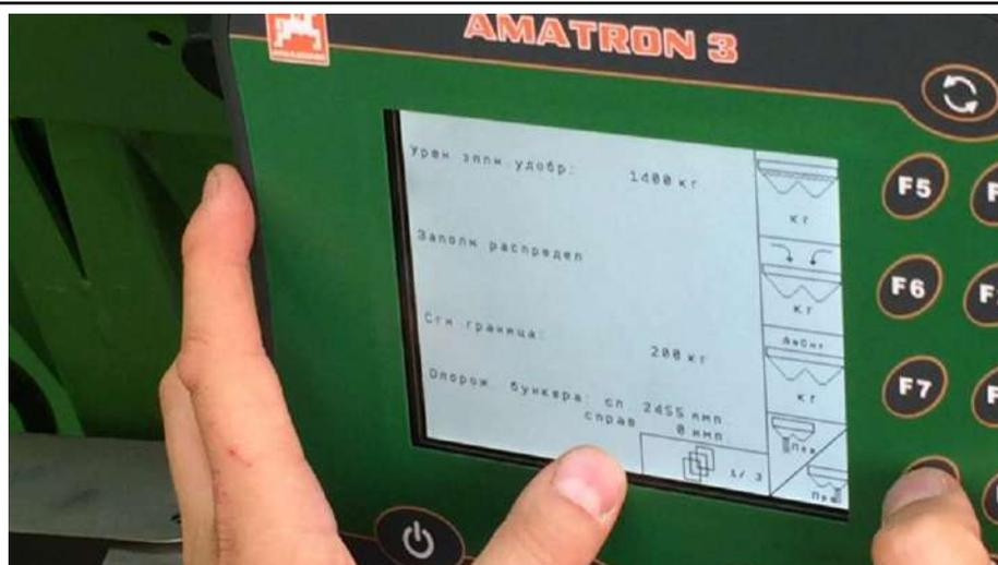
Рисунок 11.22 – Включение функции опорожнение бункера
