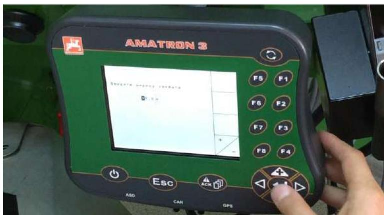
Рисунок 11.13 – Настройка ширины захвата
