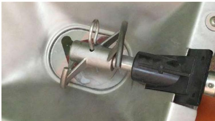
Рисунок 11.12 – Открытие заслонки распределителя
