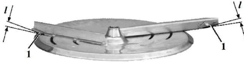
Рисунок 9.2 – Установка высоты распределения над поверхностью поля:
