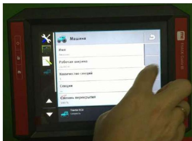
Рисунок 2.6 – Установка рабочей ширины и количества секций
