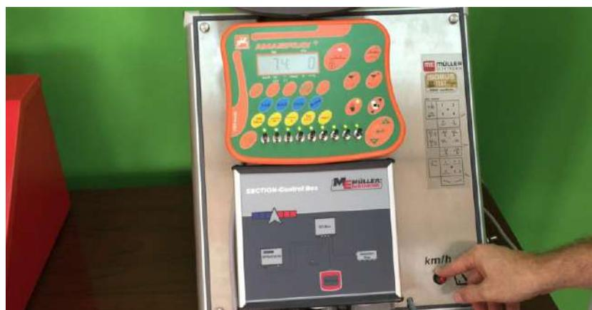
Рисунок 5.11 – Изменение скорости движения агрегата
