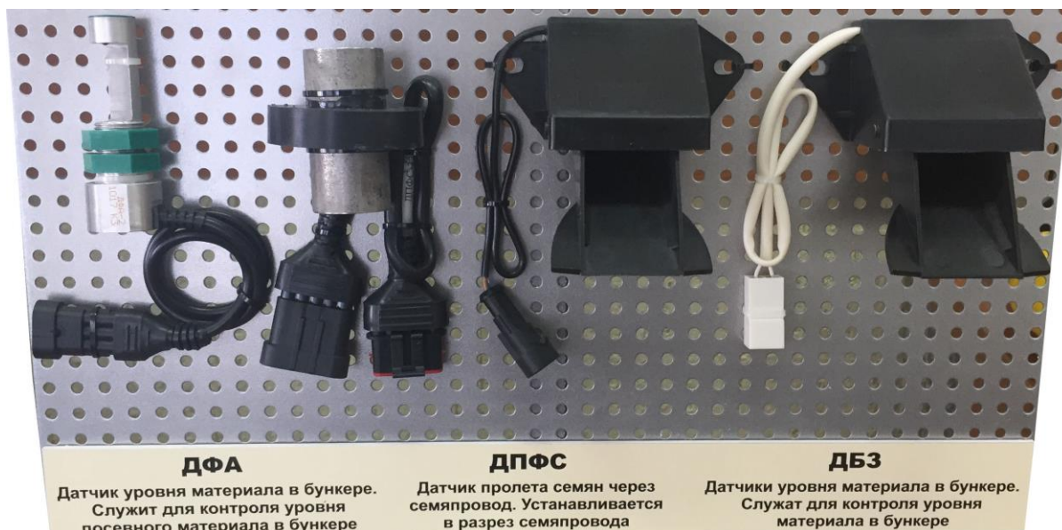
Рисунок 14.4 – Датчики уровня материала в бункере (ДФА), пролета семян через семяпровод (ДФС)
