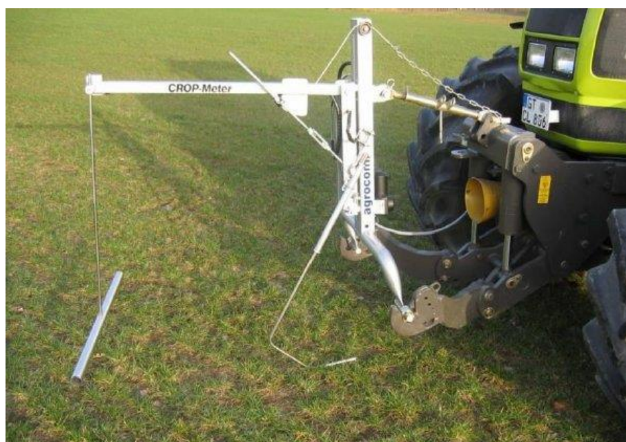
Рисунок 9 – Общий вид смонтированного на тракторе датчика Crop Meter
