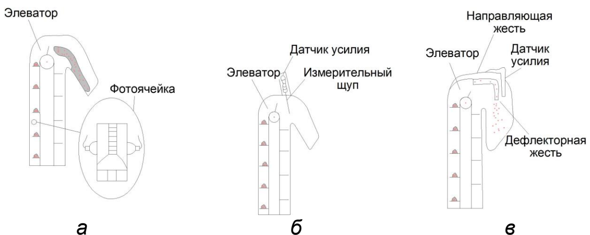
Рисунок 11 – Схема измерения объема проходящего зерна в элеваторе:
