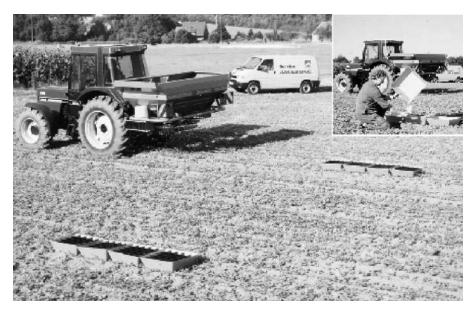
Рисунок 10.9 – Мобильный испытательный стенд
