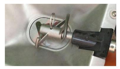
Рисунок 11.12 – Открытие заслонки распределителя
