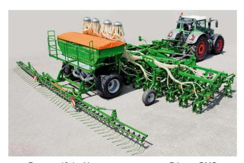
Рисунок 13.1 – Универсальная сеялка Primera DMC
