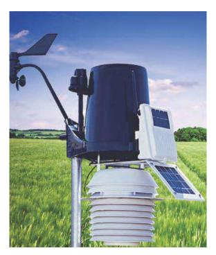
Рисунок 14.1 – Электронная агрометеостанция
