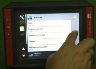
Рисунок 2.6 – Установка рабочей ширины и количества секций
