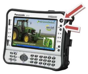
Рисунок 12.4 – Включение терминала
