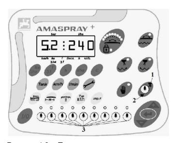
Рисунок 4.3 – Переключатель опрыскивания:
