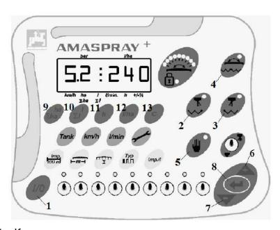
Рисунок 4.5 – Клавиши оранжевого цвета для эксплуатации опрыскивателя:
