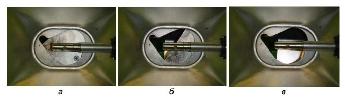
Рисунок 8.10 — Различные положения заслонки дозатора a — открыта на 10 %;  $\delta$  — открыта на 50 %;  $\varepsilon$  — открыта на 100 %
