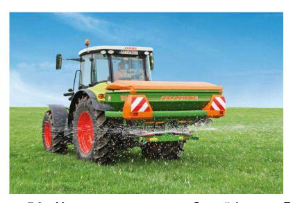
Рисунок 7.3 – Машина для внесения удобрений Amazone ZA-M
