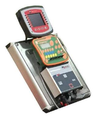
Рисунок 5.1 – Демонстрационный стенд для управления секциями опрыскивателя
