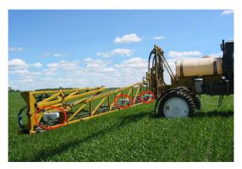
Рисунок 12.3 – Датчики GreenSeeker RT200
