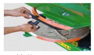
Рисунок 9.9 – Установка положения заслонки
