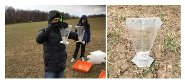
Рисунок 11.3 – Бункера для определения количества удобрений
